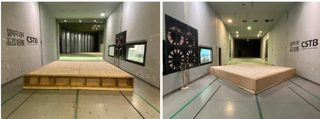
Figure 12 : Configuration 3 en soufflerie orientée à 0° (gauche) et à 45° (droite)
