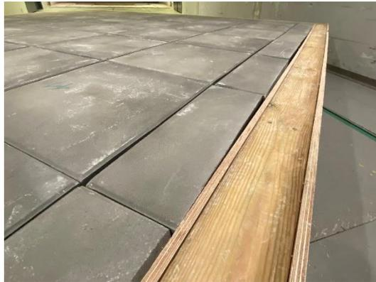
Figure 25 : Soulèvement d'une demi-dalle en configuration 6 à 45° et à 140 km/h
