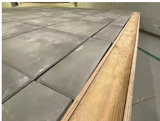
Figure 28 : Soulèvement d'une demi-dalle en configuration 7 à 45° et à 155 km/h
