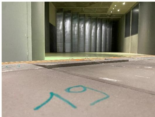
Figure 10 : Soulèvement d'une demi-dalle en configuration 4 à 45° et à 170 km/h
