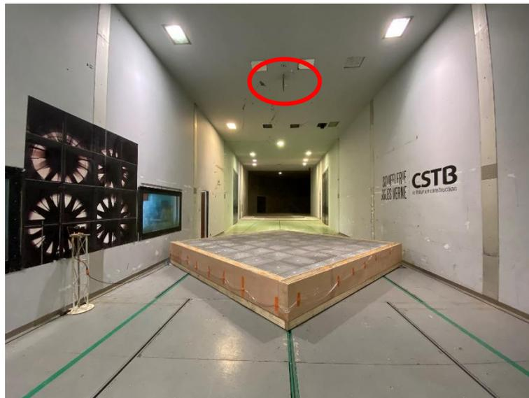
Figure 4 : Mesure de la vitesse du vent grâce au Pitot de référence au-dessus du banc d'essai
