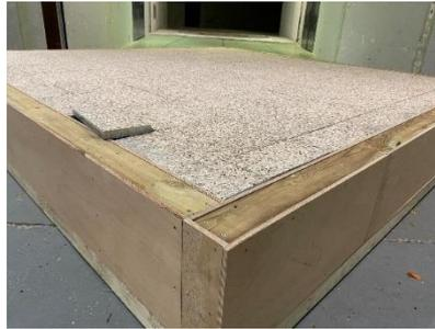
Figure 13 : Soulèvement d'une demi-dalle en configuration 3 à 45° et à 145 km/h
