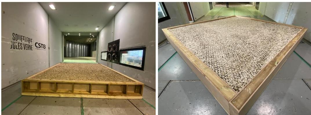
Figure 15 : Configuration 1 en soufflerie orientée à 0° (gauche) et à 45° (droite)
