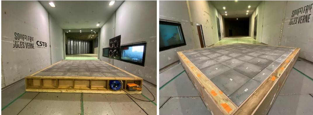
Figure 5 : Configuration 4 en soufflerie orientée à 0° (gauche) et à 45° (droite) zoom sur les voies de pression
