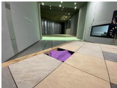
Figure 20 : Soulèvement d'une plaque en configuration 8a à 45° et à 120 km/h
